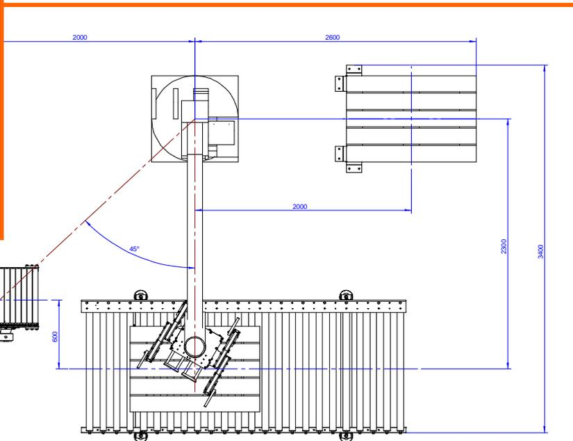
Esempio di installazione monoprodotto e singolo pallet
